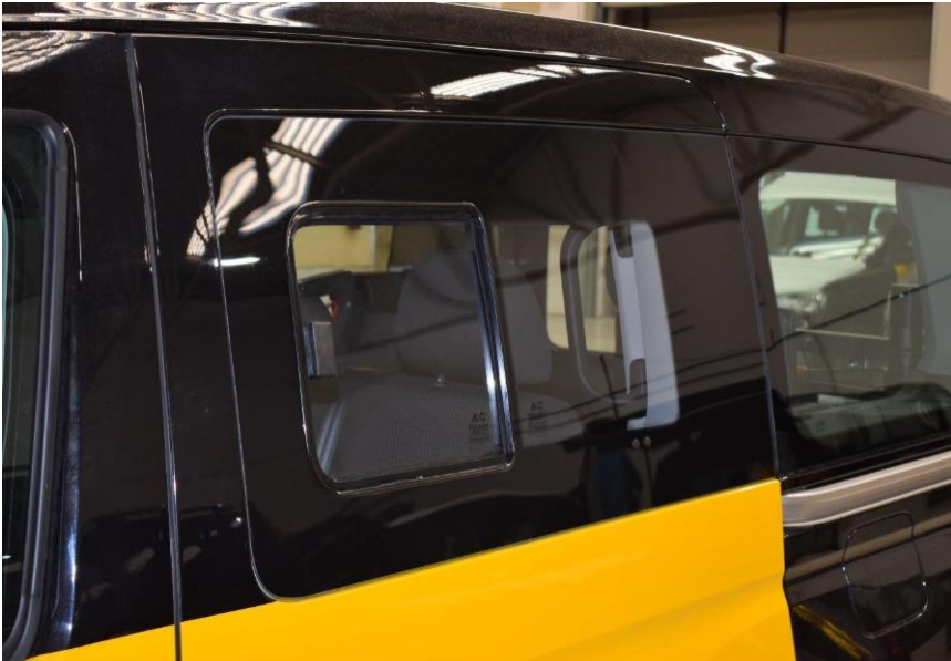
Fotografia 8 – Ventana practicable (vista exterior)
