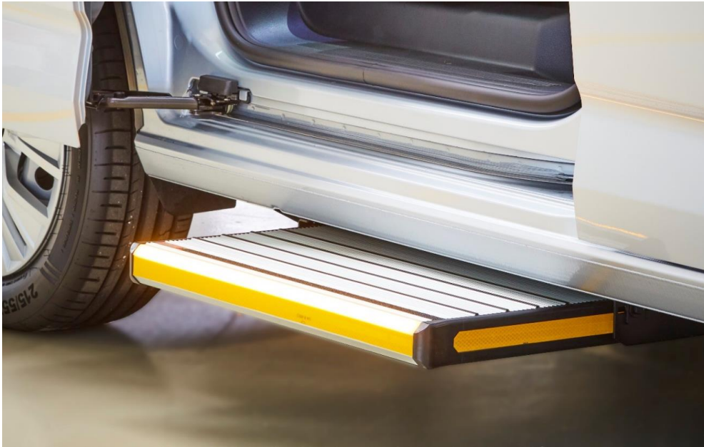
Fotografía 6 - Escalón de accionamiento eléctrico
