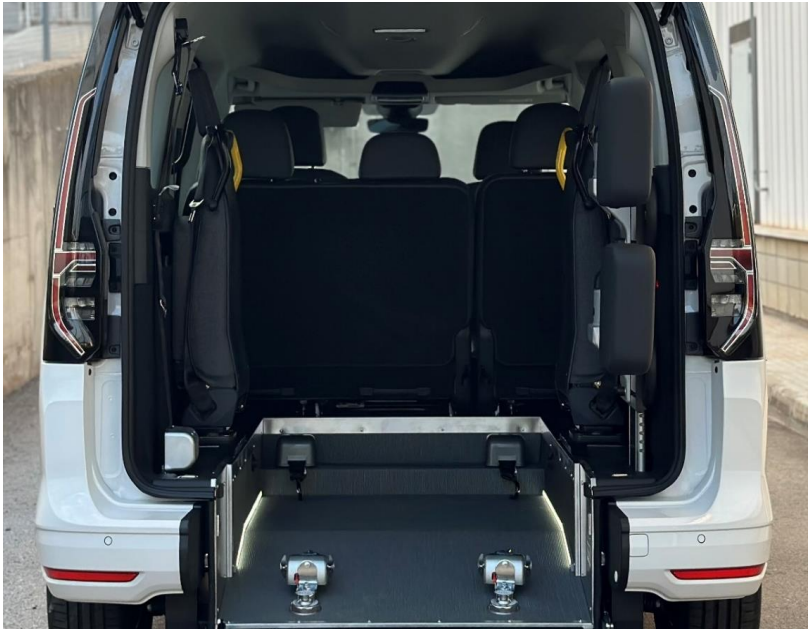
Fotografía 3 - Interior del vehículo, rampa abierta [Rebaje B'STyle]
