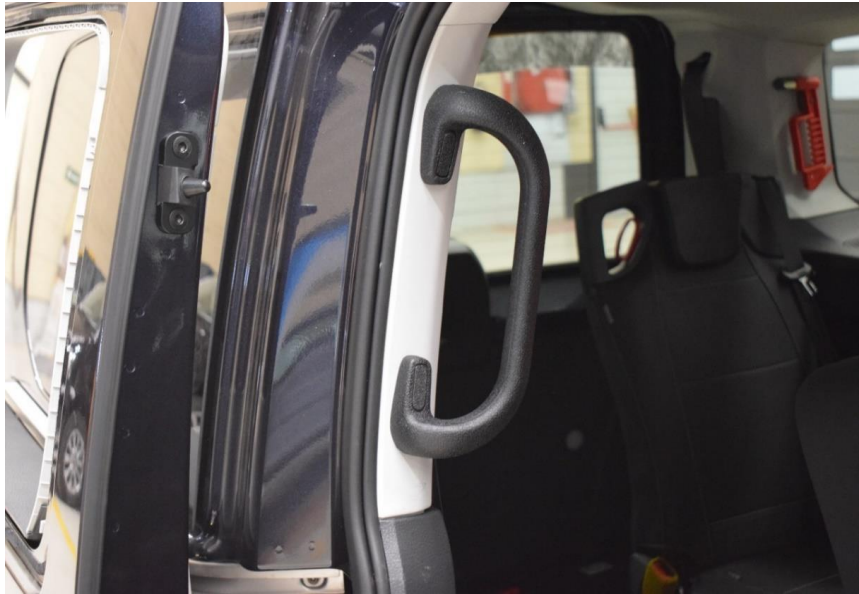
Fotografia 7 – Asidero de ayuda al acceso
